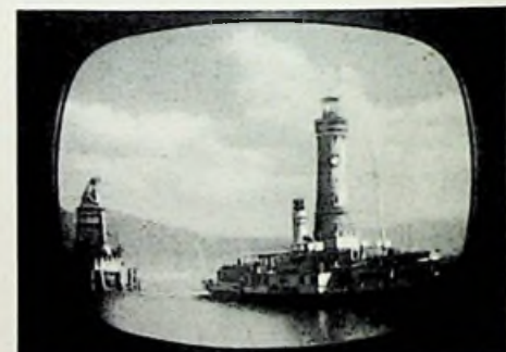
Bild 9. Einwandfrei abgestimmtes Bild nach Loslassen der Abstimm-taste
