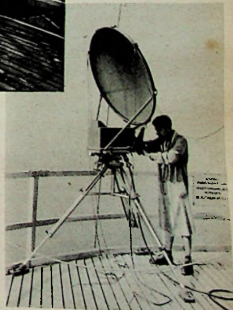
Oben und rechts: Bild 2. Fernsichtfunkstrecke auf der 70 m hohen Plattform des Antennennestes Kahlenberg bei Wien
