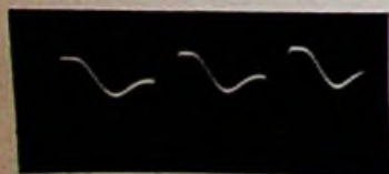
Bild 4. Spannung an der Anode der Abstimm-Verstärkerröhre bei Normalbetrieb
