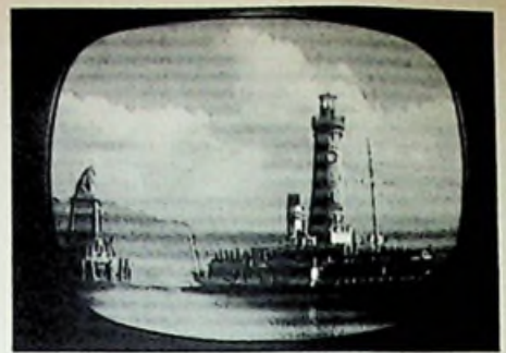
Bild 6. Oszillator nach oben verstimm. Bild zeigt Tonstreifen und Plastik
